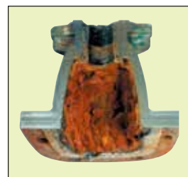
激しく腐食した鑄鉄バルブの内部
