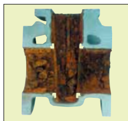
激しく腐食した鑄鉄バルブの内部
